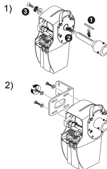
Адаптер С007 предназначен для установки привода серии CBX на секционные ворота с валом Ø25мм.
