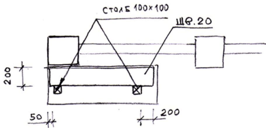
Необходимо подготовить один или два опорных столба, в зависимости от случая, который соответствует ситуации (слабые столбы или широкие ворота). Размер столбов должен быть на 50 мм больше высоты от фундаментного основания до верхней кромки ворот. Готовые столбы (или столб) устанавливают в яму и связывают с закладным элементом так, как показано на рисунке.
